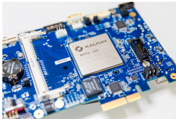
FIGURE 1.1 – Un processeur manycore : le MPPA de Kalray
